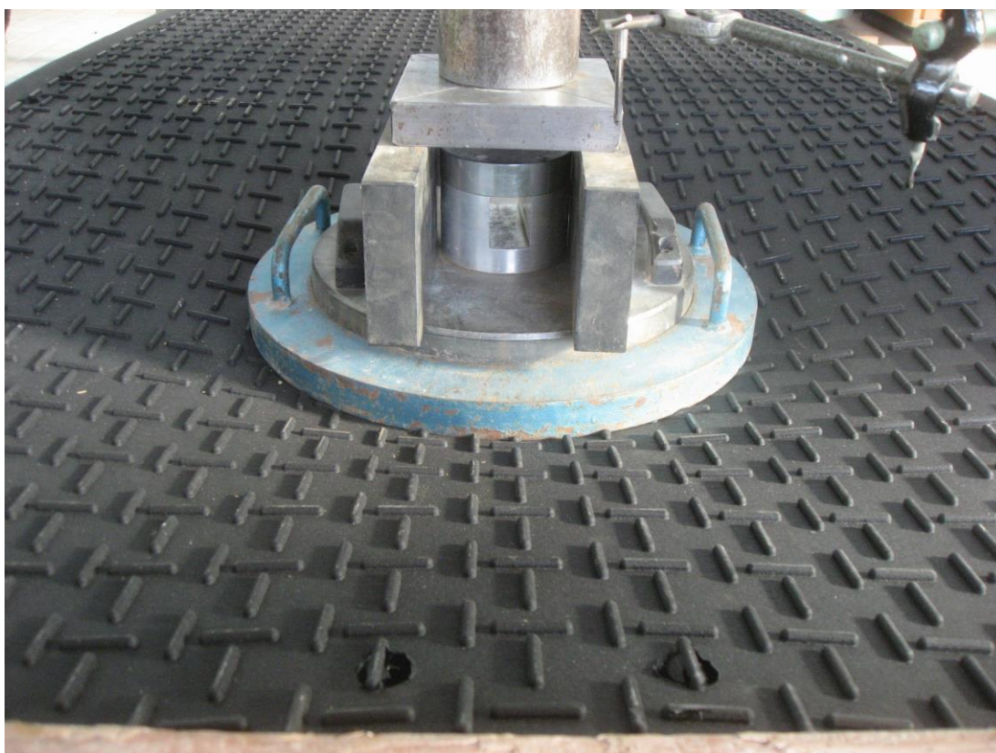
Abbildung10: Deutlich sichtbare Verformung der Tragplatte direkt nach der Belastungsprüfung auf künstlich hergestelltem Erdboden. Risse oder Abplatzungen waren nicht feststellbar.
