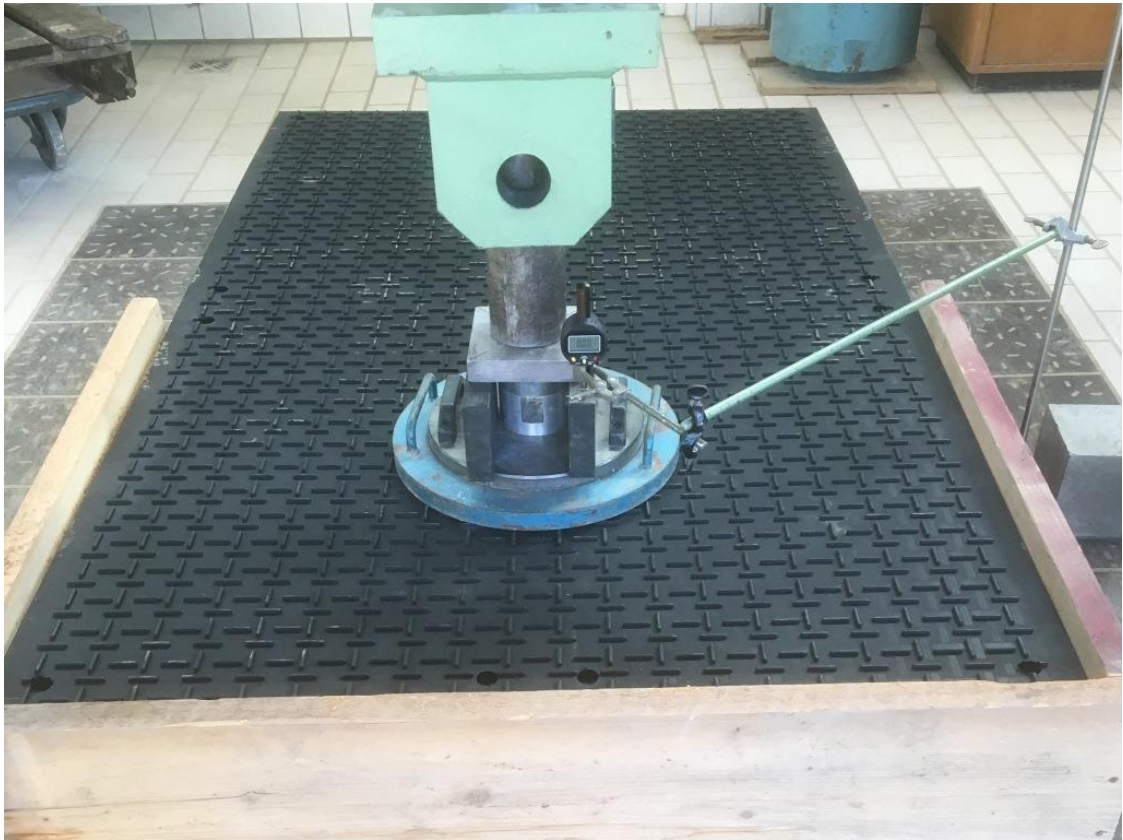
Abbildung 3 Prüfanzordnung „Hochleistungs-Fahrplatten x: tek 42 plus (XT42-Plus-001)“ auf künstlichem Baugrund
