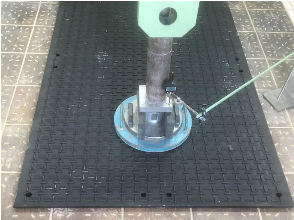
Abbildung 1: Prüfanzordnung „Hochleistungs-Fahrplatten x: tek 42 plus (XT42-Plus-001)“ auf starrem Untergrund
