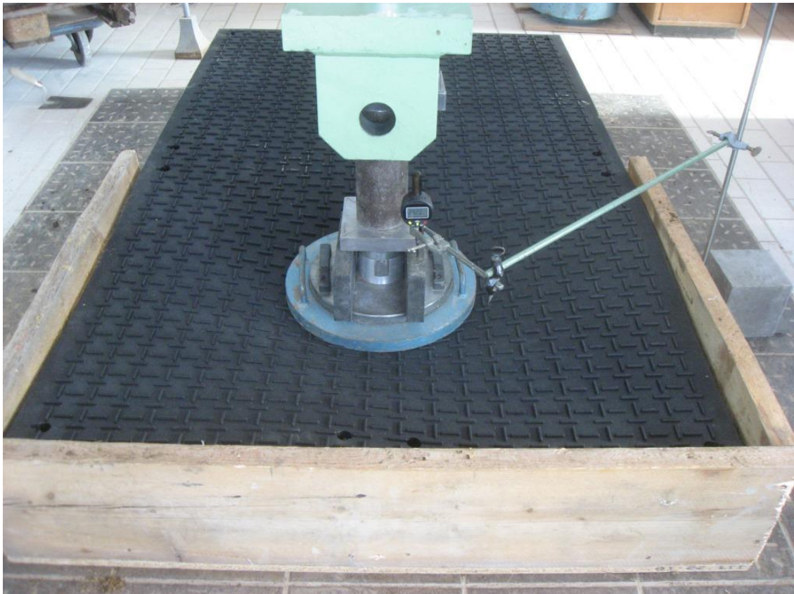
Abbildung 5: Prüfanordnung „Hochleistungs-Fahrplatten x: tek 42 plus (XT42-Plus-001)“ auf gemischtkörnigem Erdboden nach dem Belastungsversuch mit eingetretener Verformung nach dem Aufbringen der Prüflast. .
