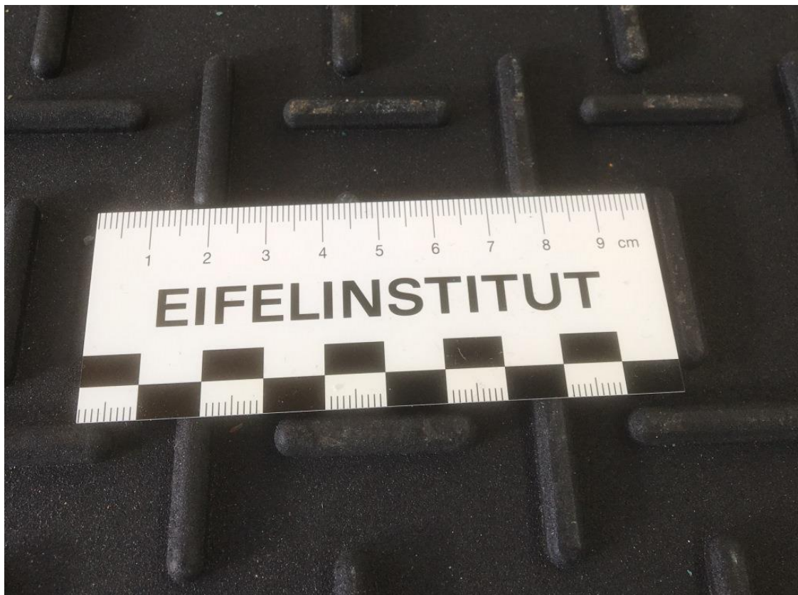
Abbildung 8: Geringe bleibende Verformung bei der Belastungsprüfung auf starrem Untergrund im Bereich der herausragenden Profilierung
