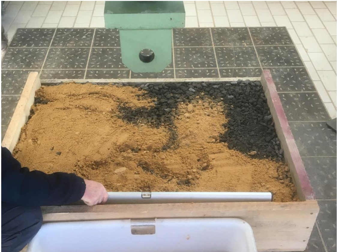
Abbildung 2: Vorbereitung des künstlich hergestellten Untergrundes durch Auftrag einer Lastausgleichenden Sandschicht auf die vorverdichtete Basaltlava-Mineralstoffschicht
