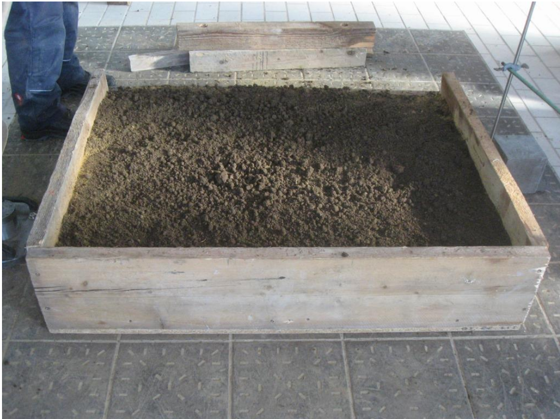
Abbildung 4: Vorbereitung des künstlich hergestellten gemischtkörnigen Erdbodens
